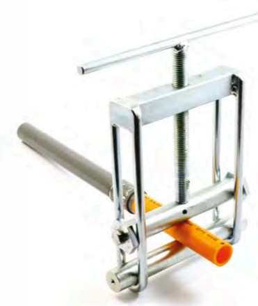
Manual Śrubowy | Ручной 20-90 mm; 63-125 mm
