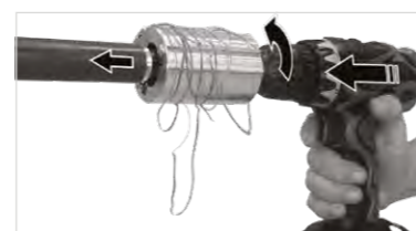
Pipe trimming Wyrównywanie końcówki rury выравнивание трубы
