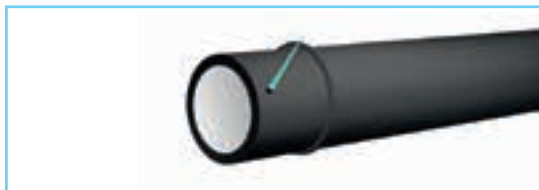
2. Смазка наружной поверхности гладкого конца трубы
