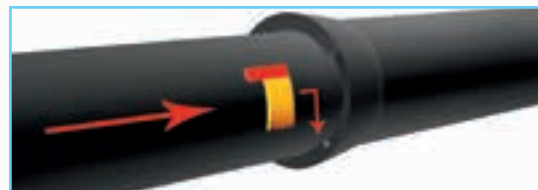
5. Стыковка труб и установка правого стопора
