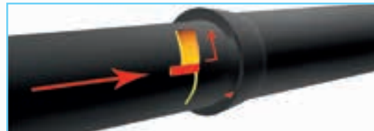
6. Установка левого стопора. Фиксация стопорной проволокой
