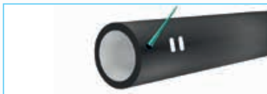
3. Смазка наружной поверхности гладкого конца трубы
