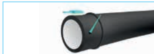
1. Очистка и смазка гладкого конца трубы
